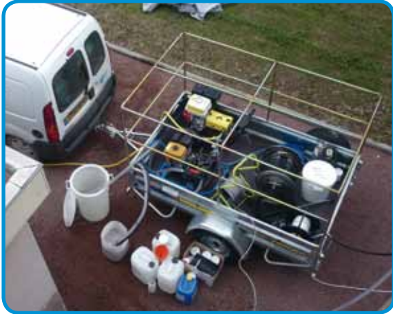
Remorque équipée : pulvérisateurs haute et basse pression, tuyaux, produits et accessoires. L'ensemble reste à l'extérieur du réservoir.
